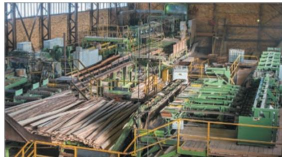
доска с получением двухкантного бруса, далее проходит через фрезер. Получаемая центральная доска толщиной 50–60 мм идет на производство бруса. Рубительная машина превращает отходы лесопиления в неокоренную топливную щепу.
