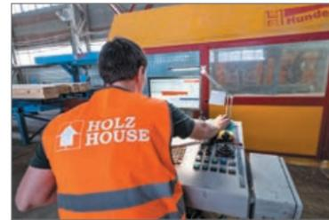
дополнительная сортировка по влажности: если содержание влаги выше 10–11%, досушиваются. Далее – предварительная острожка на четырехстороннем строгальном станке для вскрытия рисунка и возможных дефектов древесины. Согласно размещенной на участке схеме дефектов оператор отмечает их мелком и пускает пиломатериал в оптимизатор WeinigOptiCut, который по сделанному меткам вырезает нужные фрагменты в автоматическом режиме.
