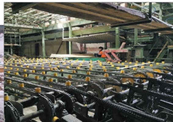
перемещает к сити щепу и опилки, образующиеся при распиловке (они утилизируются в котельной, вырабатывающей тепловую энергию для нагрева сушильного комплекса и отопления цехов).
